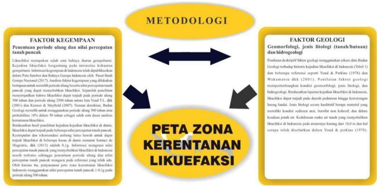
Gambar 3.12. Diagram Alir Proses Penyusunan Indeks Bahaya Likuefaksi Sumber: Atlas Zona Kerentanan Likuefaksi Indonesia, 2019
